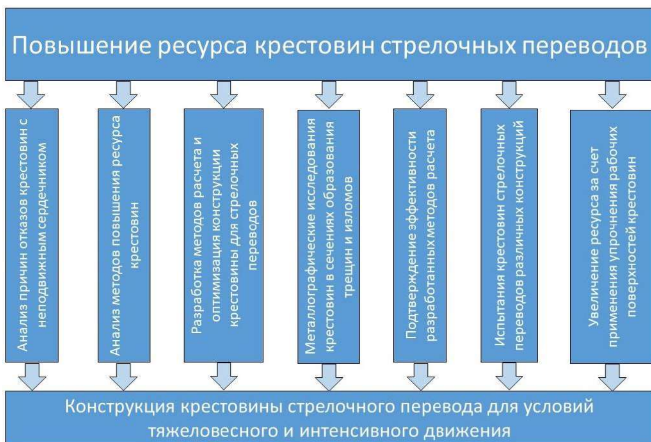
Рисунок 1.10 – Задачи, решаемые для разработки метода, получения эффективных конструкторских решений по проектированию моноблочных крестовин
