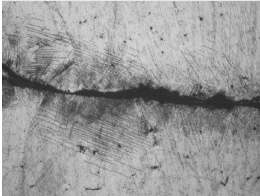
Рисунок 7.6 – Полосы сдвига, образовавшиеся у поверхности трещины под воздействием знакопеременных нагрузок.
