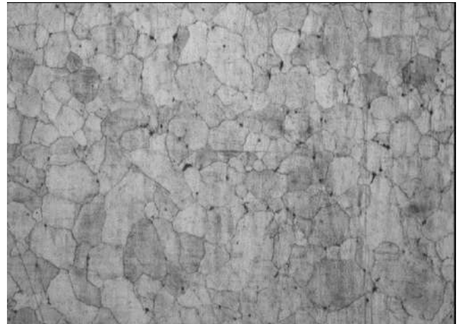
Рисунок 7.11 – Аустенит с полосами сдвига
