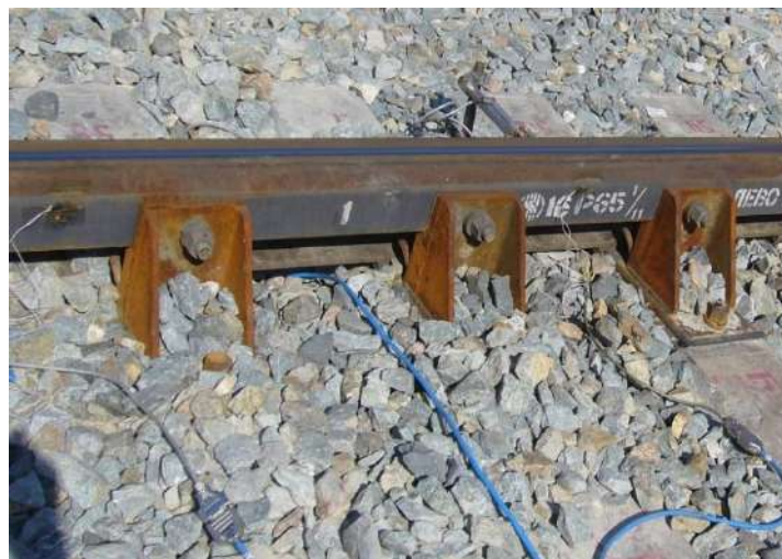
Рисунок 5.7 – Расположение тензодатчиков на контррельсе стрелочного перевода проекта Н01.004.0000.00
