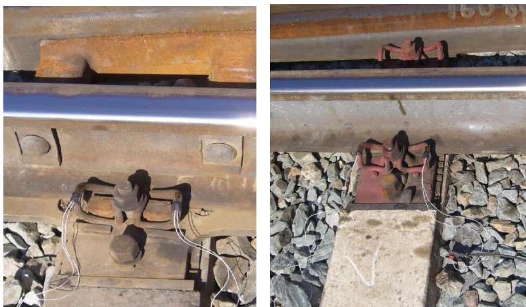
Рисунок 5.8 – Расположение тензодатчиков на клеммах SKL 12-32 стрелочного перевода Н01.004.0000.00
