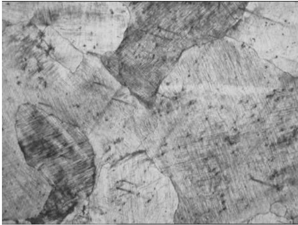
Рисунок 7.11 – Аустенит с полосами сдвига
